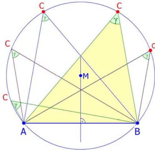
Diese Punkte C liegen alle auf einem Kreisbogen von A nach B, genannt **Fasskreis** zum Winkel  $50^\circ$ .
