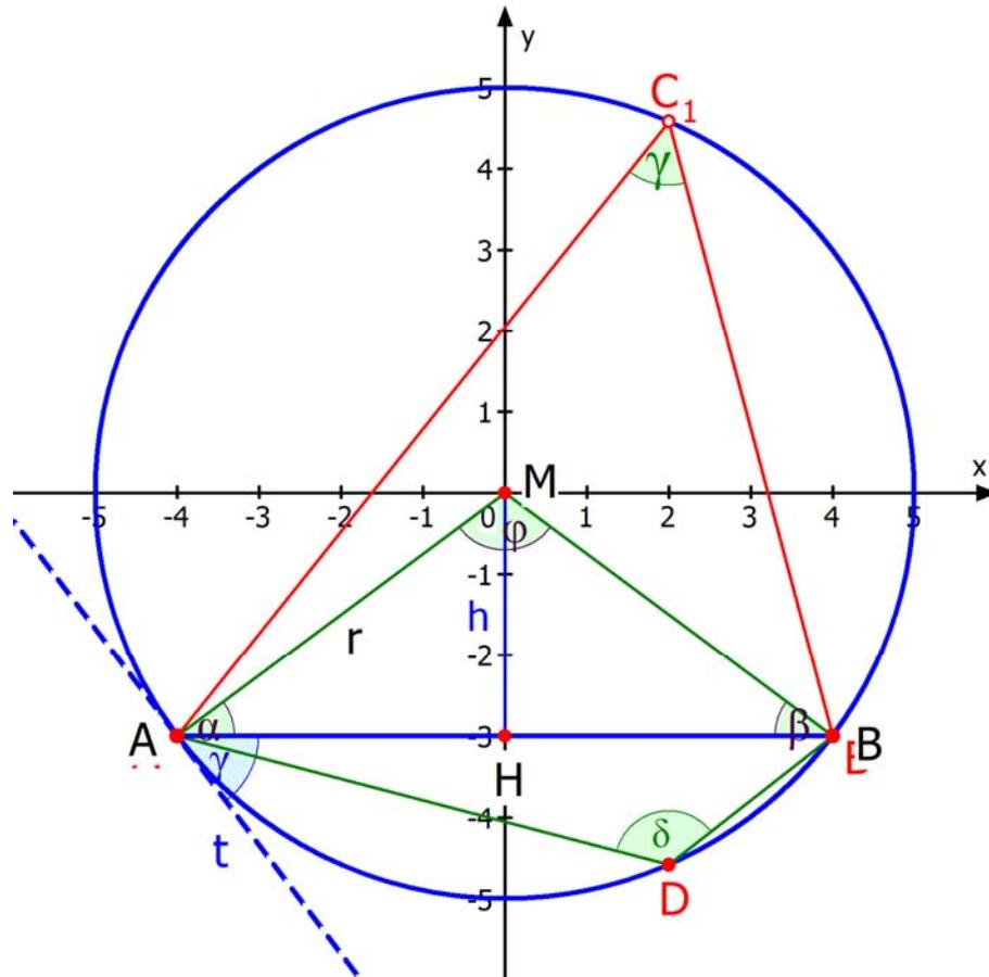
Das Dreieck ABM ist gleichschenkelig weil  $\overline{AM} = \overline{BM} = r$  ist. Im rechtwinkligen Teildreieck AHM kann man daher den Winkel bei M berechnen. Er ist  $\frac{1}{2}\varphi$ , der halbe Mittelpunktswinkel.
